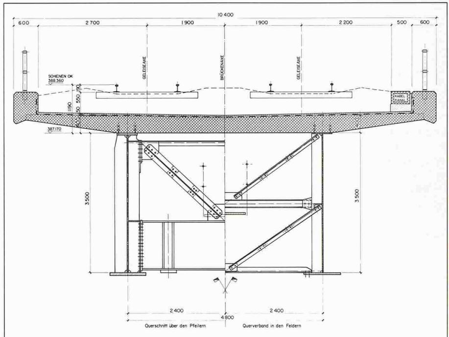
Bild 3. Die Zwischenpfeiler- und Feldquerschnitte
