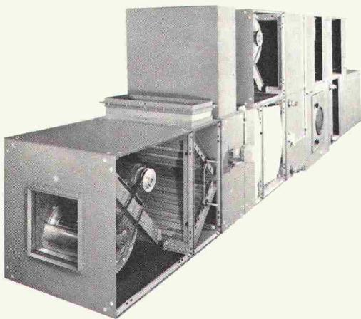
Rahmenlose patentierte Konstruktion (Keine Kältebrücken). Verzinkte, mit 180° einbrennlackierte Stahlbleche. Kubische Abmessungen. Einwandig oder doppelwandig. (4 Qualitätsstufen) Optimale Luftmengenabstufung, dadurch günstiger Preis.
