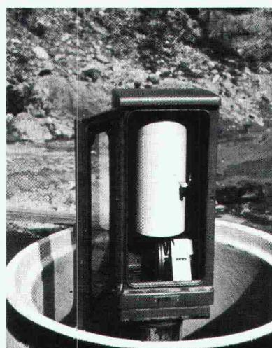
Wasserspiegelkontrollen mit Pegel
