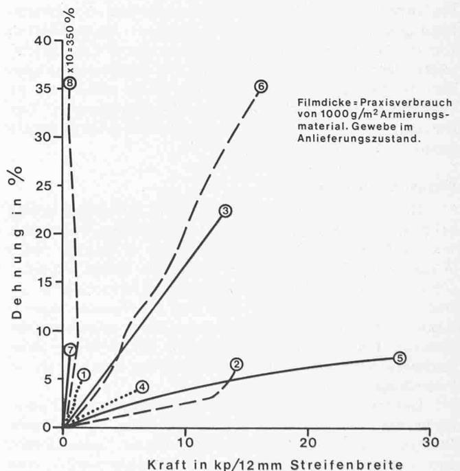
Bild 7. Spannungs-Dehnungs-Diagramm (bei Raumtemperatur). 1 Glasvlies, 2 Glasgewebe 6/6, 3 Elasticgewebe 10/10, 4 Glasvlies und Dispersionsfassadenfarbe, 5 Glasgewebe 6/6 und Dispersionsfassadenfarbe, 6 Elasticgewebe 10/10 und Armierungsbasis für gleitende Anstricharmierungen, 7 Dispersionsfassadenfarbe, 8 Armierungsbasis für gleitende Anstricharmierungen
