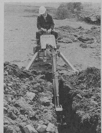
Benzinmotor betätigt den hydraulischen Antrieb.
