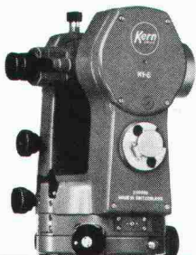
Kern K 1-S. Ingenieurtheodolit mit Skalenablesung
