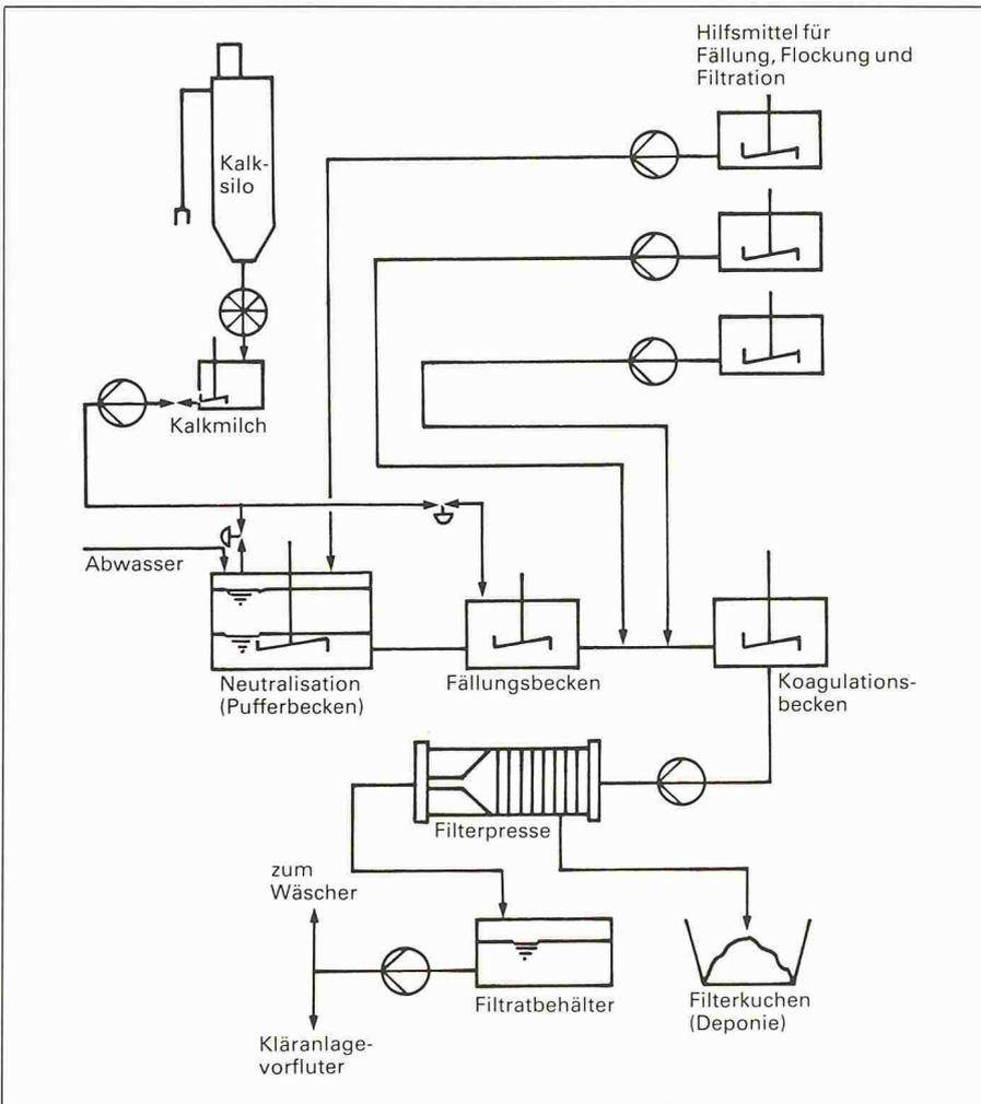
Bild 5. Prinzipschema einer Aufbereitungsanlage für Abwasser aus Rauchgaswaschanlage
