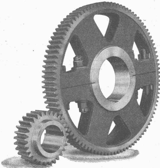
Stirnradgetriebe mit gehärteten und geschliffenen Ritzeln
