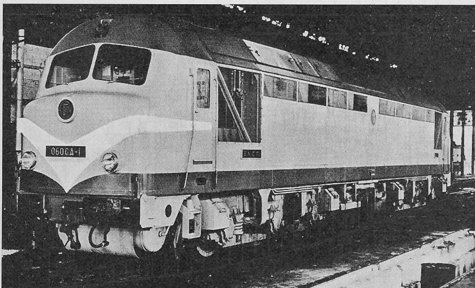
Bild 17. Lokomotive von 2400 PS mit zwei Freikolben-Gruppen
