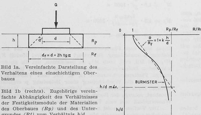
Bild 1a. Vereinfachte Darstellung des Verhaltens eines einschichtigen Oberbaues
