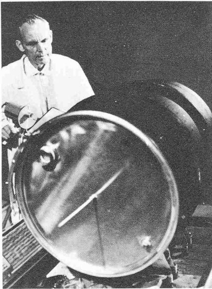
Der Erfinder des «Wärmefasses», Carlyle S. Herick, bei einer Temperaturmessung am Versuchs-Wärmespeicher. Die Warmluftgebläse links und rechts im Bild simulieren die Sonnenwärmezufuhr. Der dünne Stab in der Fassmitte ist die «Impfstelle» zur Auslösung des Gefriervorgangs, der die gespeicherte Wärme freisetzt
