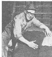
vor dem Aufsetzen des Formkastens: Giesser Josef Signer klebt den Modellsand an das Modell eines Dieselmotorkolbens.
