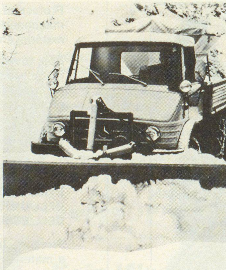
Die Unimog-Schneepflug-Streuerkombination arbeitet bei 20-30 km/h bis in den letzten Winkel.
