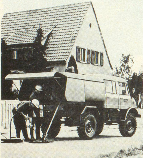
Unimog-Hochdruck-Kanalspüleinrichtung 1000-1200 m Tagesleistung.
