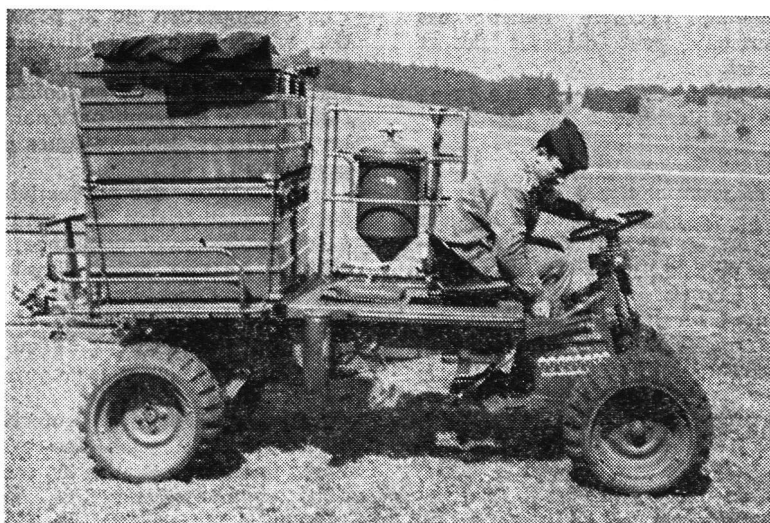
BERKEFELD -Trinkwasseraufbereiter AQUA-SERVER, 2 m 3 /h, aufmontiert auf kraka, konnte bei dem Fallschirmabwurf in Altenstadt am 28./29. März 1968 unmittelbar nach der Landung in voller Funktion eingesetzt werden
