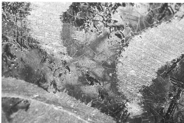
Abb. 10 Detailansicht der Kugelflasche von Abb. 9. Unter den Ablagerungen ist das bereits ausgebildete Rissnetzwerk zu erkennen. Breite des Ausschnitts ca. 7 mm.
