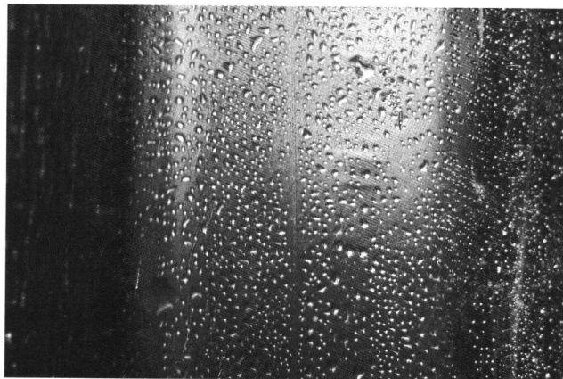
Abb. 5 Detailansicht der Flasche von Abb. 4; Tropfenbildung an der Innenwandung des Flaschenhalses. Breite des Ausschnitts ca. 14 mm.
