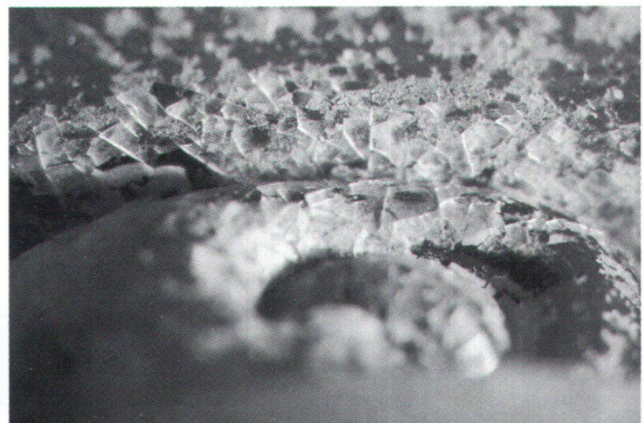
Abb. 16 Detailansicht des Trinkglases von Abb. 15. Regelmäßig abplatzende Gelschichtschollen. Breite des Ausschnitts ca. 7 mm.
