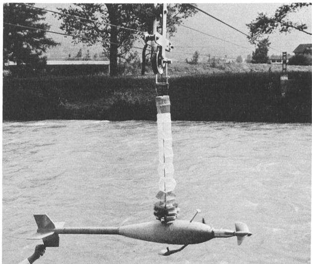
Foto di sopra. Dettaglio di un mulinello fissato al pesosonda (salmone). Il salmone, massa profilata a forma di pesce, con il timone stabilizzatore può essere spostato orizzontalmente ed in profondità per la misura della velocità nel punto desiderato del corso d'acqua. I segnali del mulinello come pure quelli del toccafondo (visibile sotto il peso) sono trasmessi via conduttore elettrico.
