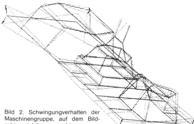
Bild 2. Schwingungsverhalten der Maschinengruppe, auf dem Bildschirm sichtbar gemacht.
