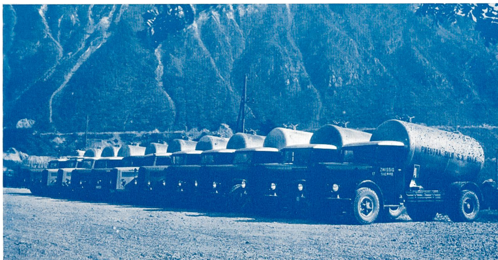
Teil eines Fahrzeugparkes für Zementtransporte — Liegende Pneumat.-Transportbehälter bis 8,5 t Nutzlast
