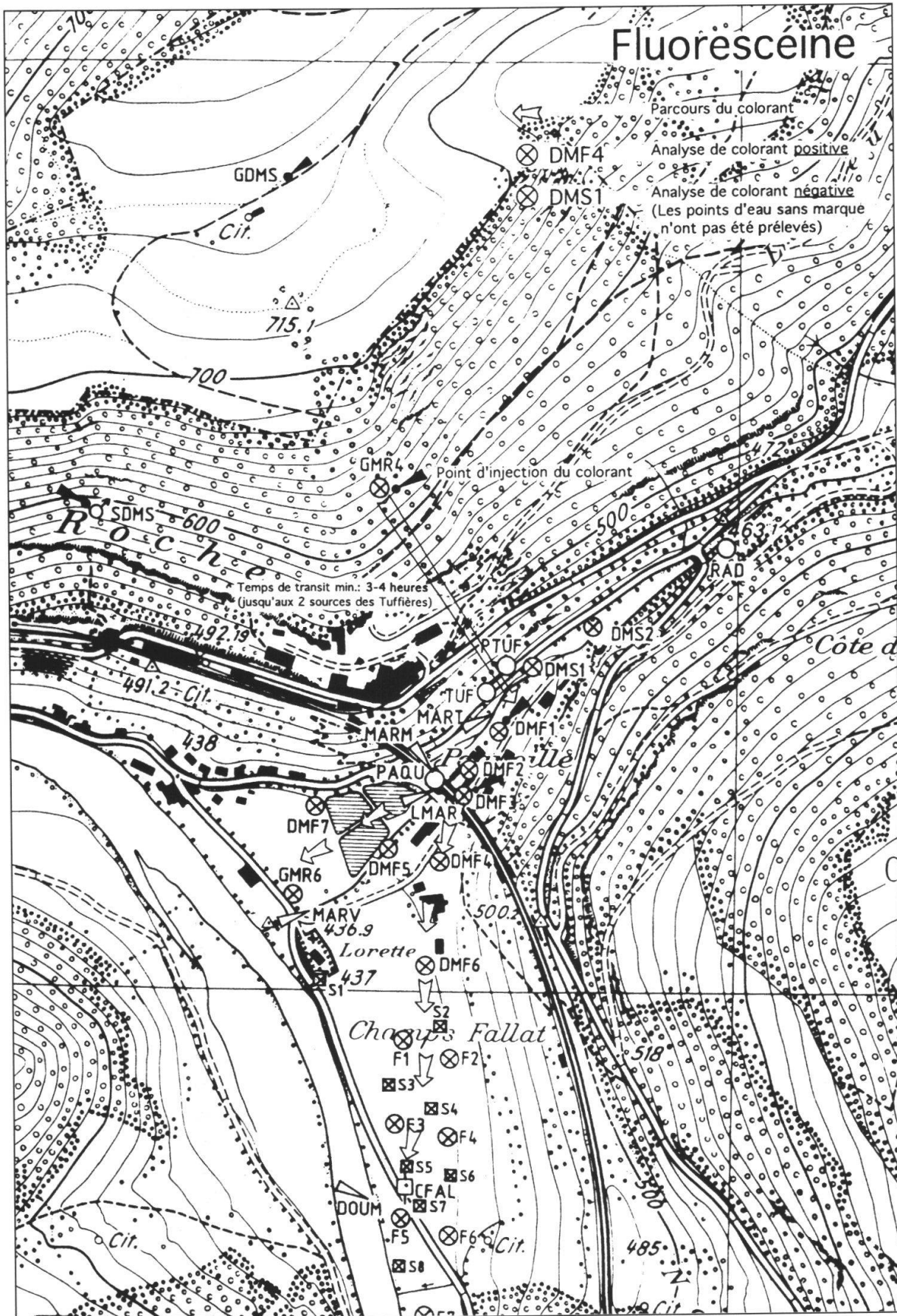
Fig. 3: Färbversuch Herbst 1995, Tracer Fluorescein (aus MFR 1996).
