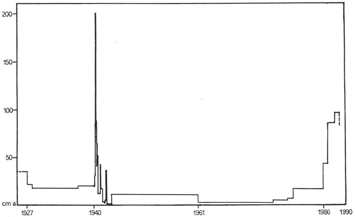
Fig. 5 Spostamenti misurati presso la chiesa di Campo
