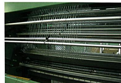
Abb. 1: GWM 1200 RR Kettenwirkmaschine
