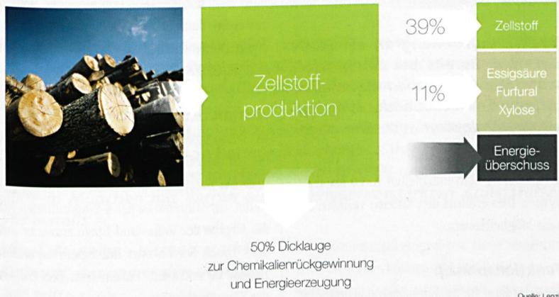
Abb. 3: Holz als Rohmaterial und Brennstoff für die Zellstoffproduktion
