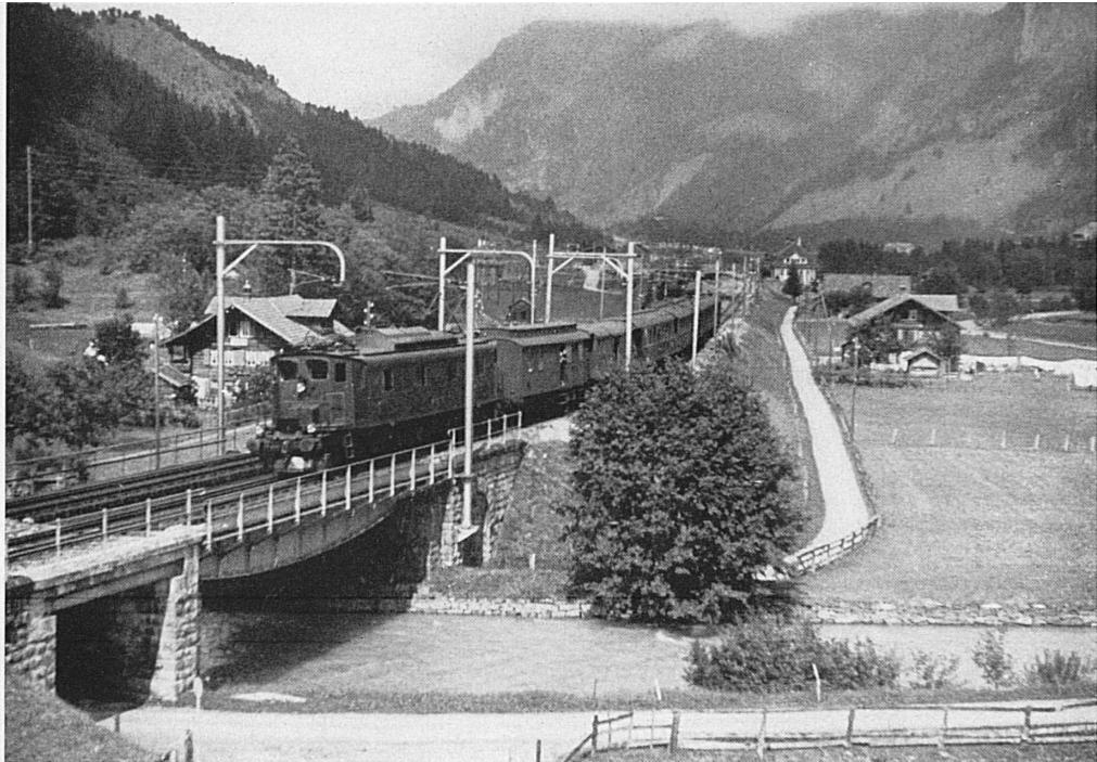
Links oben und Mitte: Die Züge der Lötschbergbahn werden durchgehend mit neuem Rollmaterial geführt. Das untere der beiden Bilder zeigt eine der neuen vierachsigen Schnellzuglokomotiven Bo-Bo 4/4 mit angehängten Leichtstahlwagen im Bahnhof Kandersteg. — A gauche, en haut et au milieu: Les trains du Lötschberg ont été pourvus de nouveau matériel. L'image du milieu nous montre l'une des nouvelles locomotives de train direct à 4 essieux, Bo-Bo 4/4, avec wagons légers, à la gare de Kandersteg.
