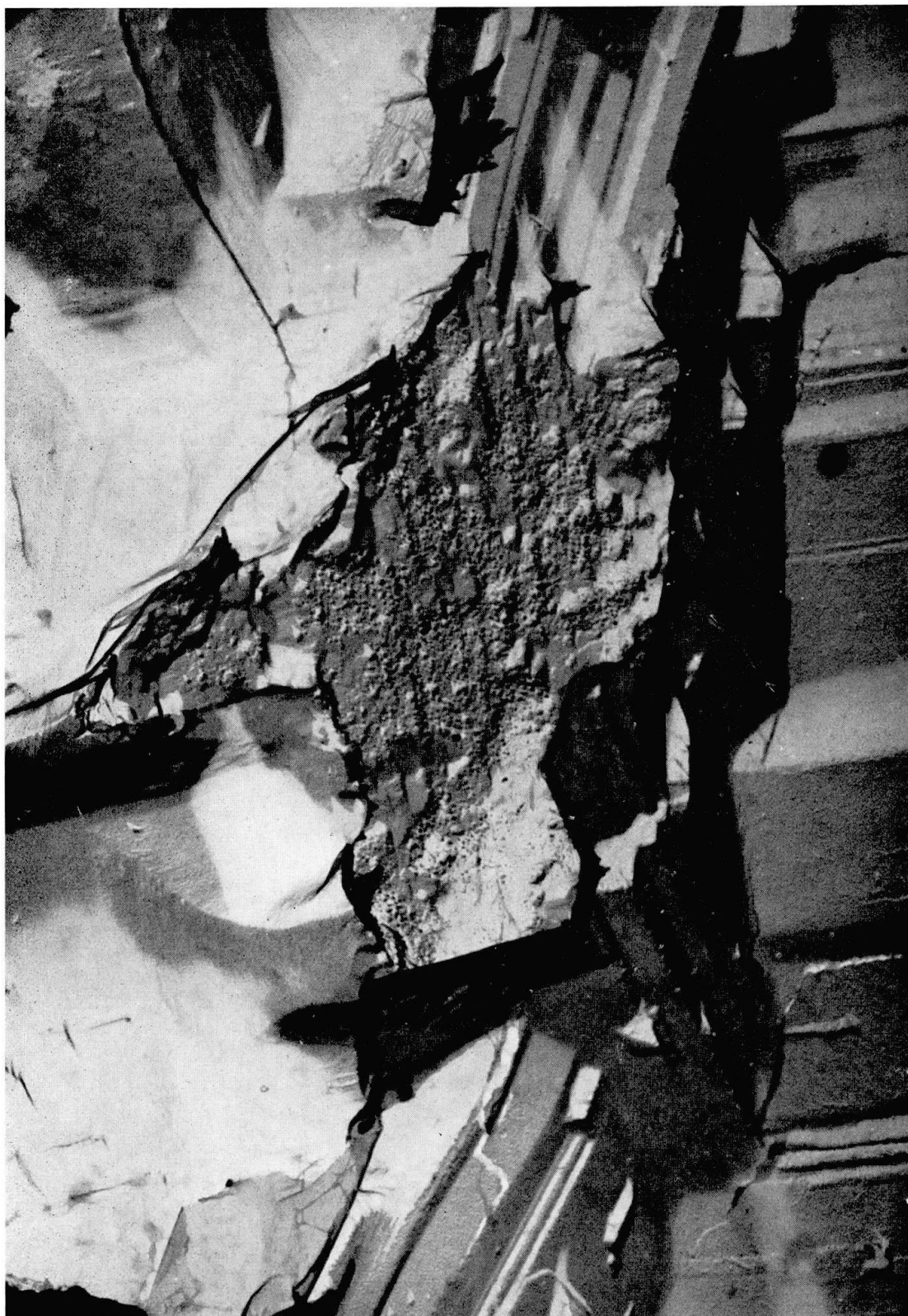
Fig. 1. Calcite, Rappensteinrûfe, Vaduz (Fürstentum Liechtenstein). Fractographie électronique. Réplique biodène ombrée. Grossissement \times 10\,000 env.
