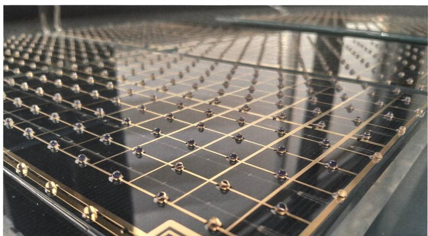
**Figure 2** Seconde approche dans laquelle l'utilisation d'un circuit imprimé transparent permet de séparer les plans des cellules à multijonctions (cellules primaires) et des cellules en silicium (cellules secondaires).
