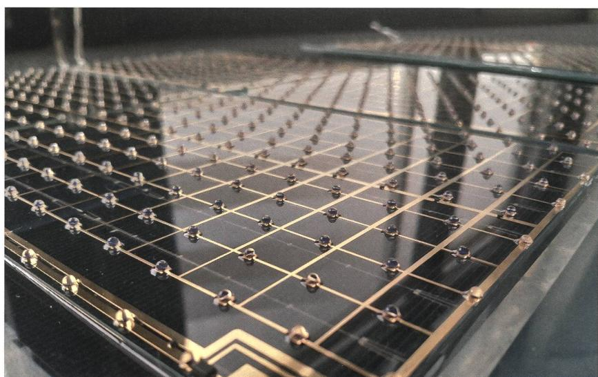
**Bild 2** Zweiter Ansatz, bei dem die Ebenen der Mehrfachsolarmodule (Primärzellen) und der Siliziumzellen (Sekundärzellen) mit einer lichtdurchlässigen Leiterplatte getrennt werden können.
