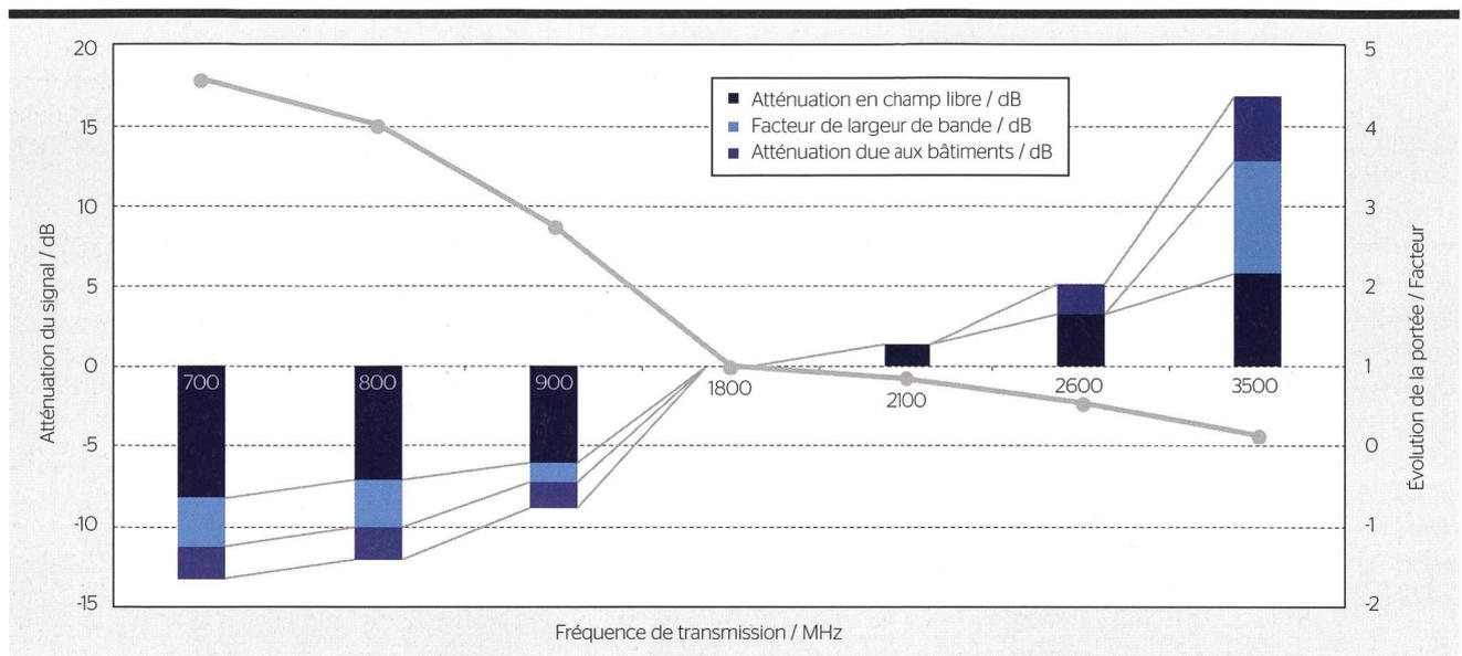
**Figure 1** Atténuation en champ libre, facteur de bande passante (pour les porteuses typiques des fréquences de transmission données) et atténuation supplémentaire due aux bâtiments pour différentes fréquences de transmission par rapport aux signaux à 1800 MHz (histogramme, échelle de gauche). La courbe grise représente la portée résultante (échelle de droite).
