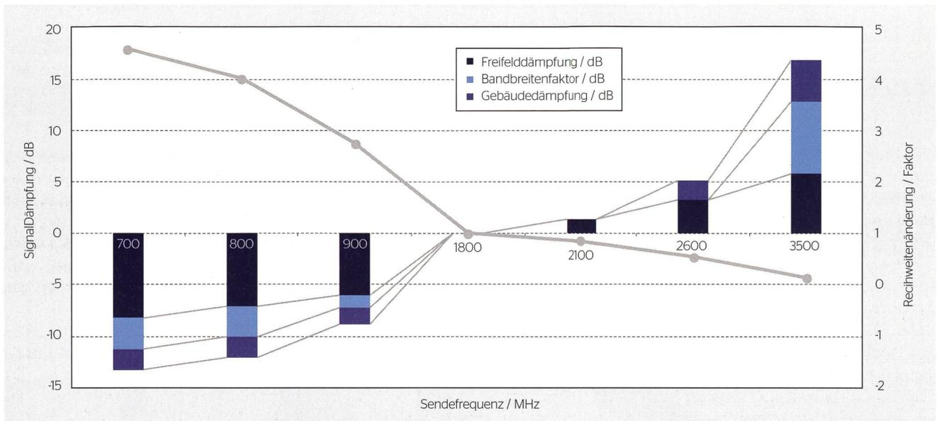
**Bild 1** Streckendämpfung, Bandbreitenfaktor (für typische Träger der jeweiligen Sendefrequenz) und zusätzliche Gebäudedämpfung für verschiedene Sendefrequenzen im Vergleich zu 1800-MHz-Signalen (Balkendiagramm, linke Skala). Die graue Kurve beschreibt die daraus resultierende Reichweite (rechte Skala).
