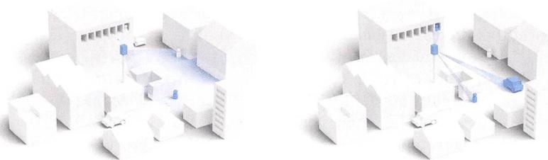
**Figure 2** Avec les antennes conventionnelles, les signaux sont toujours envoyés dans toute la zone de transmission (à gauche), tandis que les antennes adaptatives dirigent les signaux de manière ciblée vers l'utilisateur (à droite).
