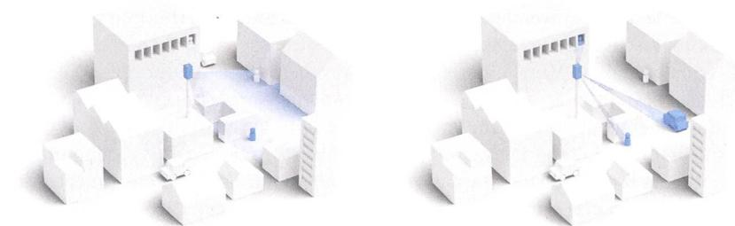
**Bild 2** Links: Bei konventionellen Antennen werden die Signale stets in die ganze Funkzelle geschickt. Rechts: Adaptive Antennen senden die Signale gezielt zum Nutzer.
