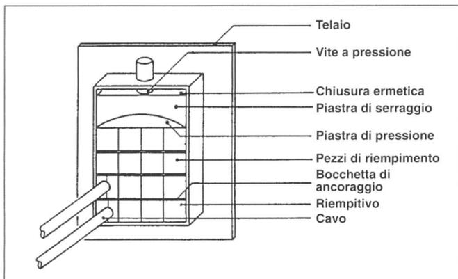
Figura 9 Esempio di una attraversata stagna ai gas
