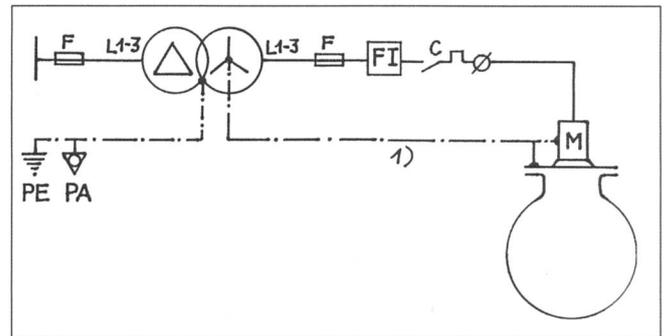
**Bild 8 Galvanische Auftrennung**
