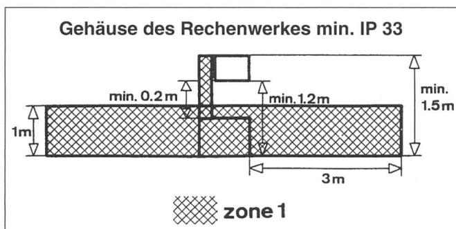
Bild 1 Ex-Zone bei Benzinzapsäule mit Tank-Automat (SEV 3307)
