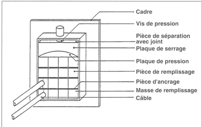
Fig. 9 Exemple d'une traversée étanche aux gaz
