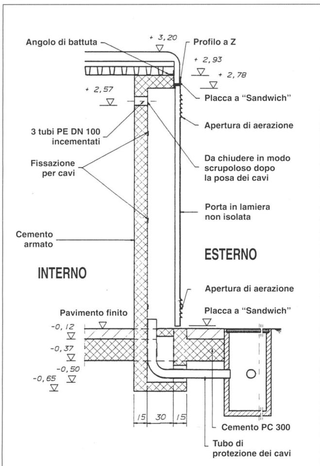
Figura 10 Zona della salita dei cavi con pozzetto (esempio)
