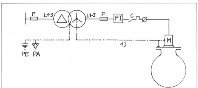
Figura 8 Separazione galvanica
