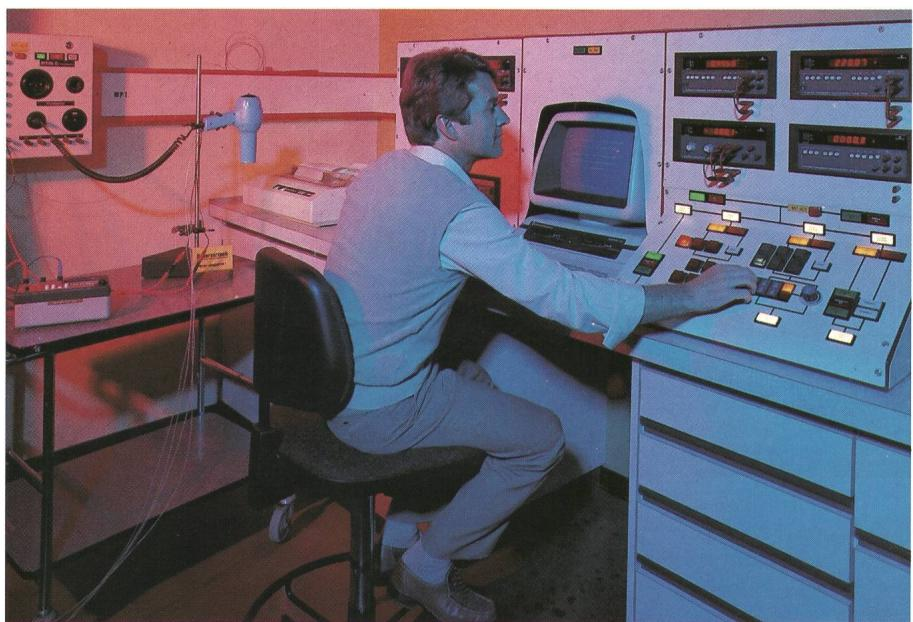
**Dispositif de mesure triphasé commandé par ordinateur permettant de mesurer et d'enregistrer le courant, la tension, la puissance, la résistance et la température. Ce dispositif utilisé à la Station d'essais des matériaux y a été développé.**
