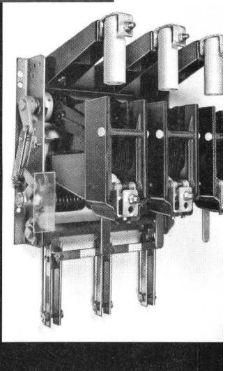
3poliger DRIESCHER-Innenraum-Lasttrennschalter Typ H 24 für 24kV 630 A mit linear bewegten Schaltmessern und Lichtbogenlöschung nach dem Hartgas-Prinzip.
