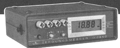
D-3950 Digital-Erdungsmesser für 2-pol- und 4-pol-Messungen, hohe Auflösung, Messumfang 0,01Ω ... 200 kΩ
