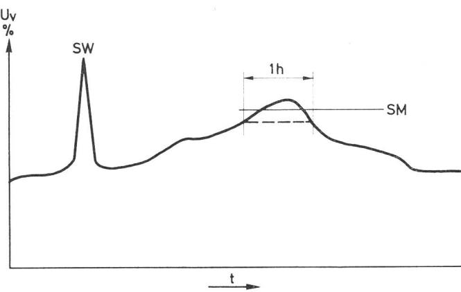
Fig. 2 Bestimmung des Spitzenwertes SW und des grössten Stundenmittels SM der Oberwellenspannung  $U_v$  (in Prozenten der Nennspannung) auf dem Registrierstreifen (Messperiode 5–7 Tage)
