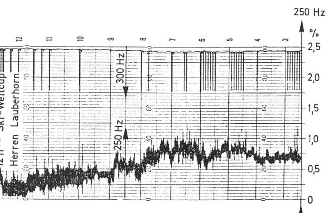
**Fig. 1** Erzeugung von Oberwellen durch Fernsehempfangsgeräte, Verlauf des Oberwellenpegels für 250 und 300 Hz an der 16-kV-Sammelschiene einer Netzstation, gemessen am 22. Januar 1977
