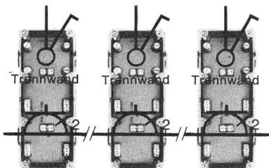
Der WEIDMANN-Einlasskasten H 137 ermöglicht jetzt den rationellen Anschluss 2 getrennter Drehstrom-Stromkreise in einen Einlasskasten. Die wahlweise einsetzbaren Trennwände und die vielen Anschlussmöglichkeiten erlauben die verschiedensten Varianten zur Trennung der Stromkreise. Ein weiterer Vorteil für eine schnelle und saubere Montage sind die im Kunststoffgehäuse eingelassenen Metallgewindebuchsen zur Aufnahme sämtlicher normierter Befestigungsplatten.
