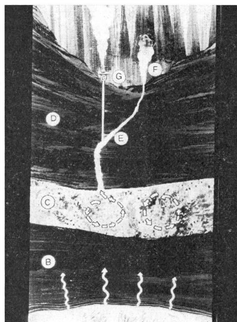
**Fig. 3** Geologische Verhältnisse in der Nähe der Erdoberfläche an einem Punkt, wo die Erdwärme genutzt werden kann
