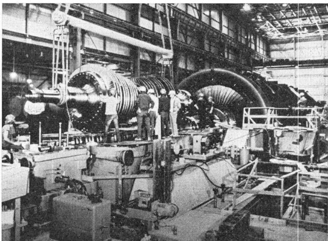
**Fig. 6 Aufbau einer Grosssturbine in der Fabrik vor der Ablieferung
