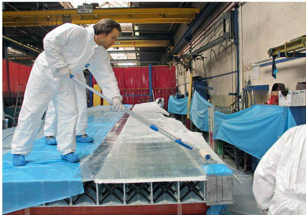
01+02 Umlaminierung der einzelnen Segmente und Aufbringen des Dünnschichtbelags (Fotos: Christoph Sturzenegger/FVK)
