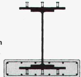
**Geilinger Stahlstützen F30-F180**
