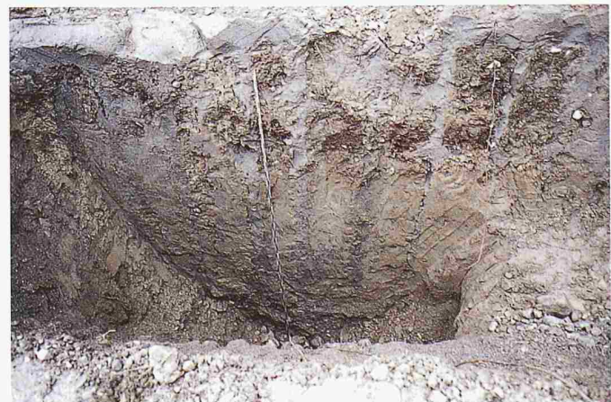
Ausgrabung der Versuchsstrecke. Man erkennt sehr schön die Vollflächigkeit und die Rippen, die durch die Form der Rammbohle gebildet wurden
