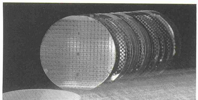
Fertige integrierte Schaltungen auf einem «Waver» vor dem Zersägen in die einzelnen Siliziumplättchen
