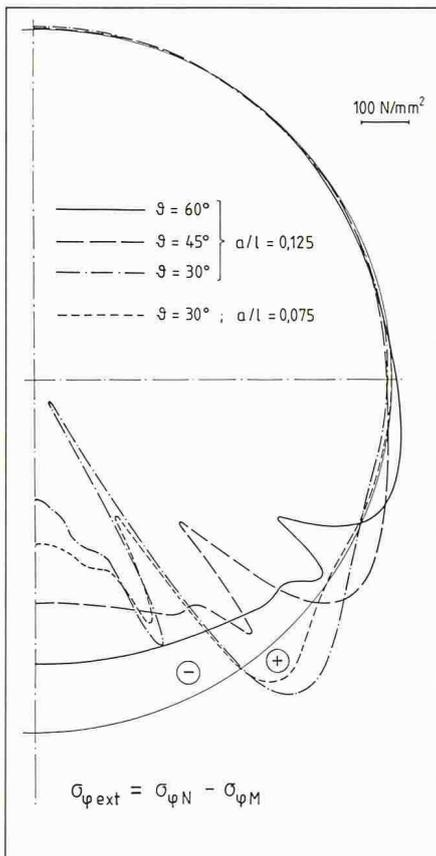
Bild 2. Verläufe von  $\sigma_{\varphi ext}$  über den Behälterquerschnitt am äusseren Sattelrand für verschiedene Umschliessungswinkel
