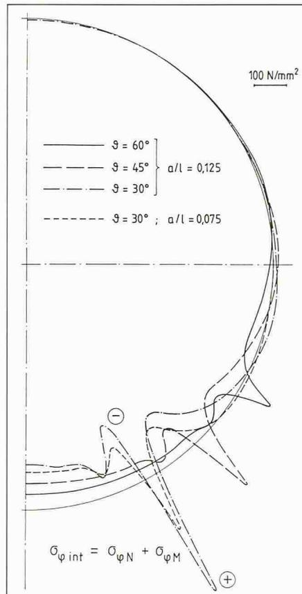
Bild 4. Verläufe von  $\sigma_{\varphi int}$  über den Behälterquerschnitt am äusseren Sattelrand für verschiedene Umschliessungswinkel
