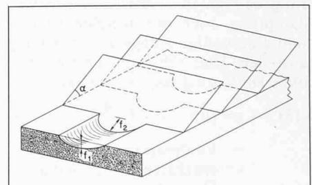
Bild 2. Verbesserung der Empfindlichkeit durch schräge Ebenen
