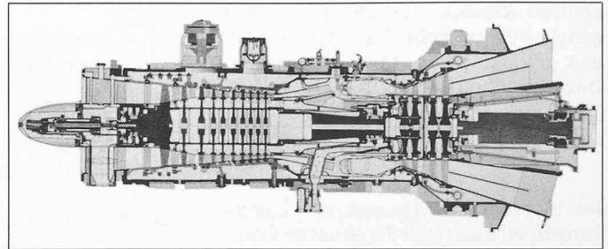
Bild 5. Schnitt durch die Sulzer-Gasturbine Typ 10
