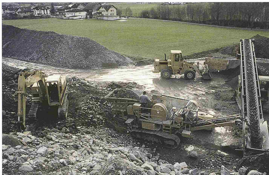
Brechen von Steinen und Aussieben zu Auflastfiltermaterial
