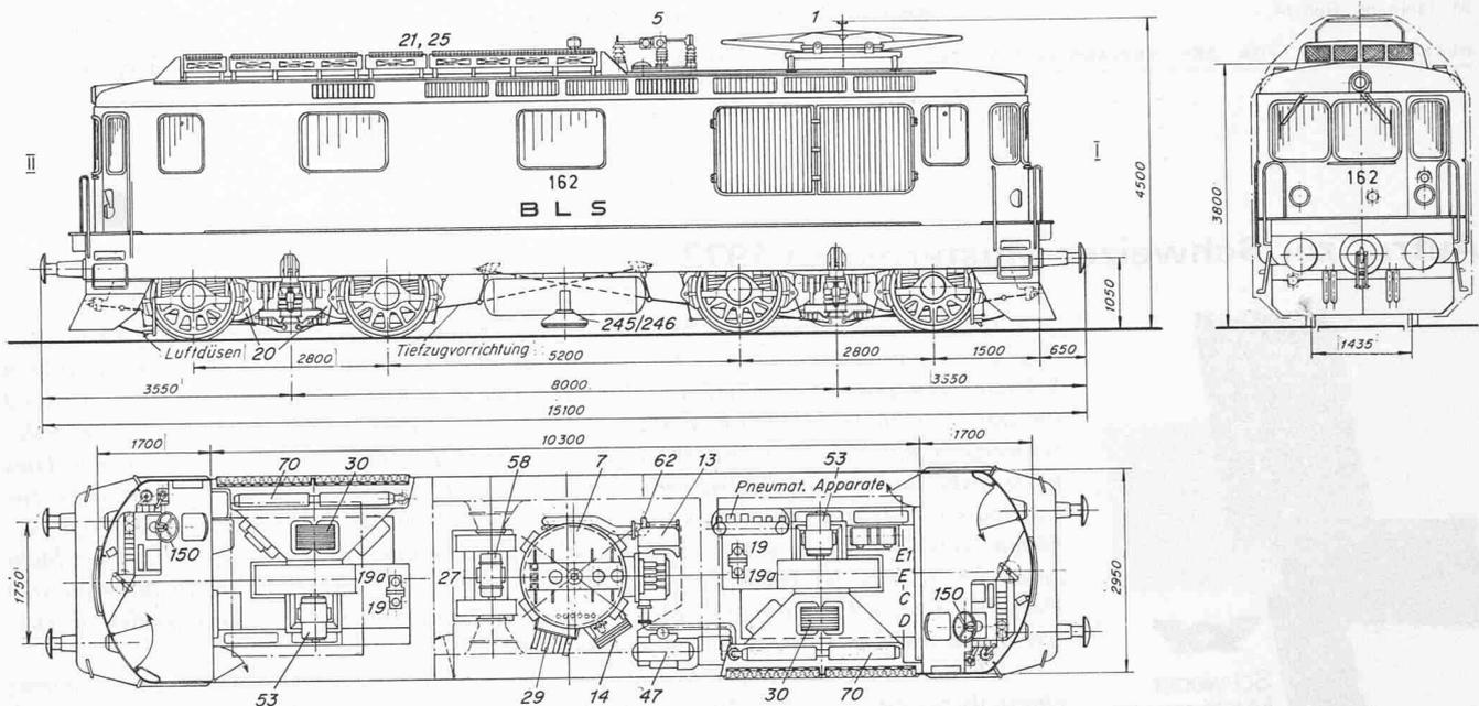
Bild 1. Typenbild der Dioden-Gleichrichter-Lokomotive Re 4/4 162 der Bern-Lötschberg-Simplon-Bahn
