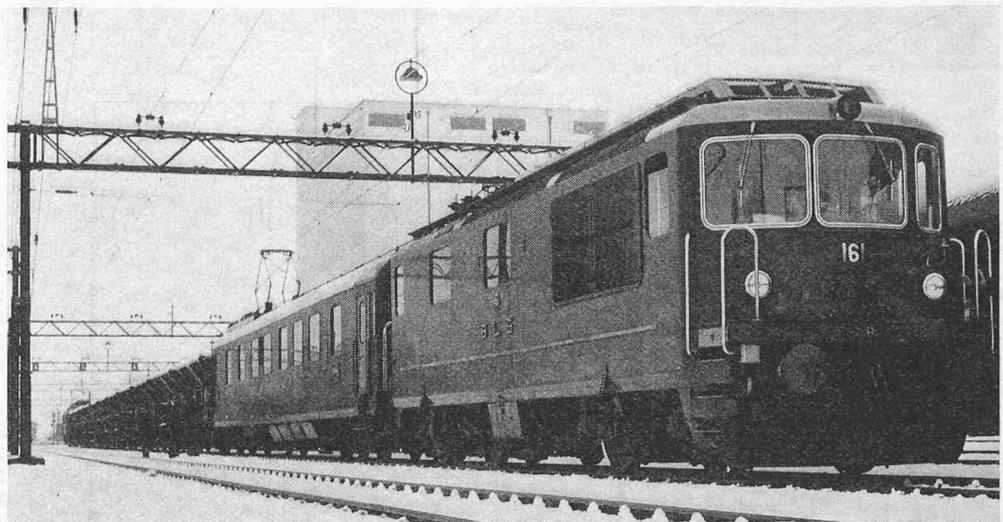
Auf der SBB-Strecke Bern–Thun wurden die nur einschienig isolierten und mit 125 Hz gespeisten Gleisstromkreise ebenfalls gestört. Die über 100 m langen Isolierabschnitte wurden wie bereits früher auf der BLS-Strecke ebenfalls mit Filtern ausgerüstet. Seit dem 18. September 1972 kann nun die Thyristor-Lokomotive Re 4/4 161 fahrplanmässig zwischen Brig und Bern eingesetzt werden. Weitere Messungen auf dem Netz der SBB sind für 1973 vorgesehen.
