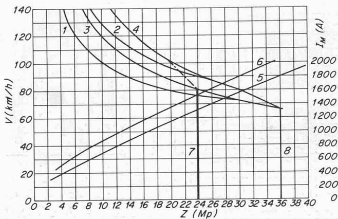
Bild 5. Geschwindigkeits-Zugkraft-Charakteristik der Thyristor-Stromrichter-Lokomotive Re 4/4 161
