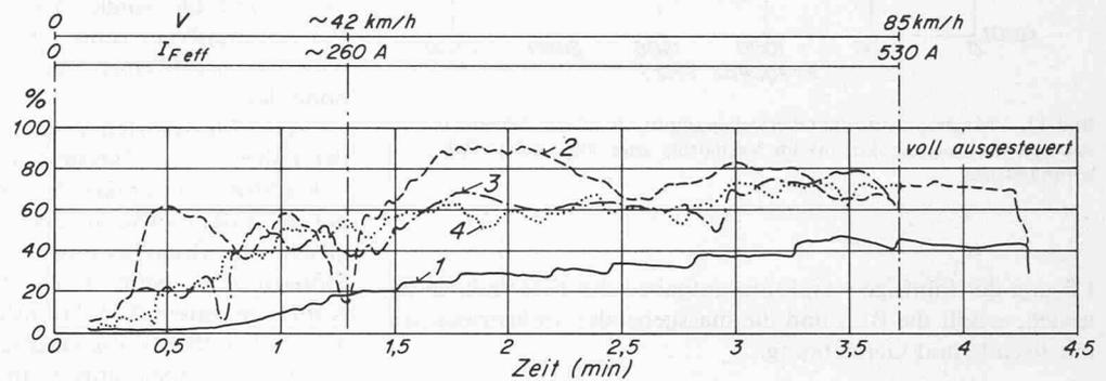
Bild 12. Verlauf der psophometrisch bewerteten Störströme im Fahrleitungsnetz
