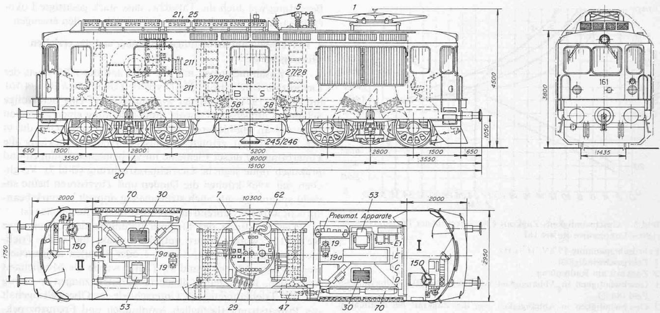
Bild 3. Typenbild der Thyristor-Stromrichter-Lokomotive Re 4/4 161 der Bern-Lötschberg-Simplon-Bahn
