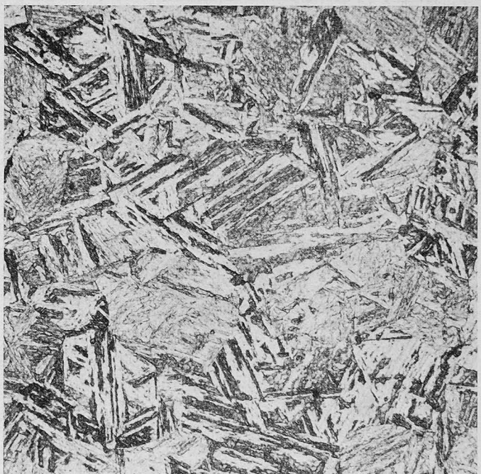
Bild 2. Gefüge von Stahlguss 185 V, Vergrösserung 250fach
