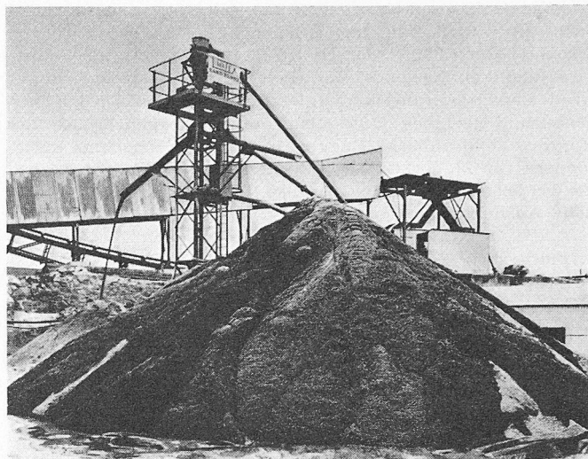
Bild 9. Linatex-Sandabschneider , Leistung 4 bis 46 m 3 /h
