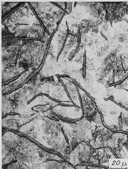
Bild 3. Gusseisen mit Lamellengraphit mit perlitischer Grundmasse (geätzt)
