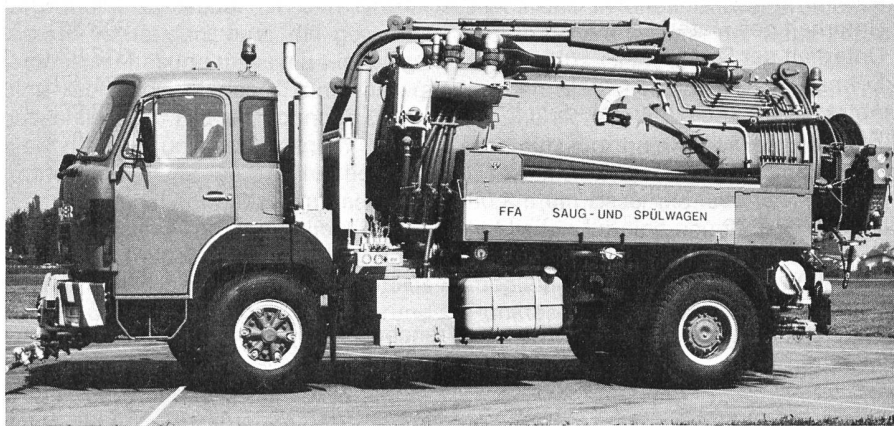
Abb. 1. FFA-Zweiachsspül- und -saugkombi mit Hochdruckreinigungsanlage und Fernsteuerung. Einsatzgebiet durch Waschbalken, abnehmbare Schneckenpumpe auf Strassenreinigung und Katastropheneinsatz erweitert.
