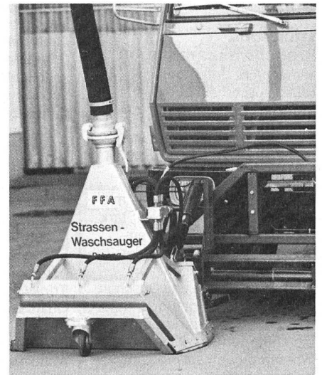
Abb. 5. Mit dem Strassenwaschsauger wird der Staub und Schmutz abgeschwemmt und mit dem Wasser in die Schlammkammer abgesaugt. Dadurch entsteht keine zusätzliche Belastung für die Kanalisation, wie dies beim Schwemmen der Fall ist.
