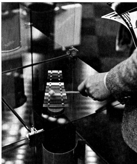
Abb. 6. Auch «Spielernaturen» kamen auf der Envitec auf ihre Rechnung. Dieses Xylophon am Stand der Hoesch Stahlwerke allerdings hat seine Tücken: Nicht alle Metallplättchen geben beim Anschlagen einen Ton von sich, da teilweise nichtschwingender Stahl verwendet wurde (wir werden darauf zurückkommen)
