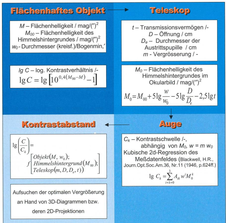
eine prinzipiell über die Bestimmung der Fixstern-Grenzgrösse abschätzbare, durch meteorologische und Lagebedingungen, aber auch durch Dämmerungseinflüsse und Mondschein bedingte Grösse. Wichtig ist der Objektkontrast  $C$ .
