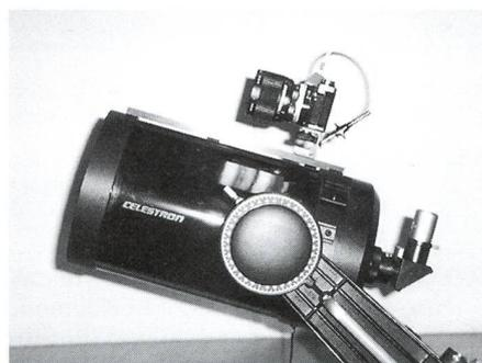
Boîtier photographique avec son objectif fixé en parallèle sur un télescope C8 doté d'une monture équatoriale.
