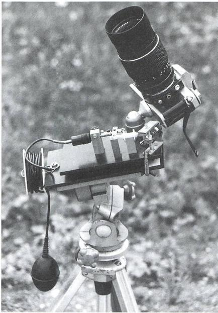
Fig. 2. Mit Luftpumpenbetrieb erschütterungsfreies Nachführen eines 200mm Teleobjektivs.
