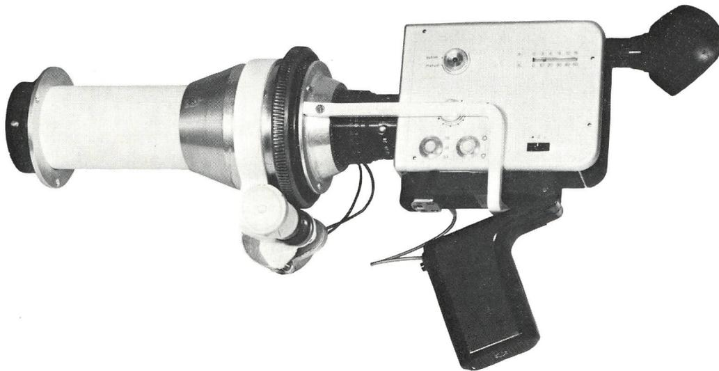
Abb. 6: Der Filmkameraansatz des Instruments von H. BRÄGGER.
