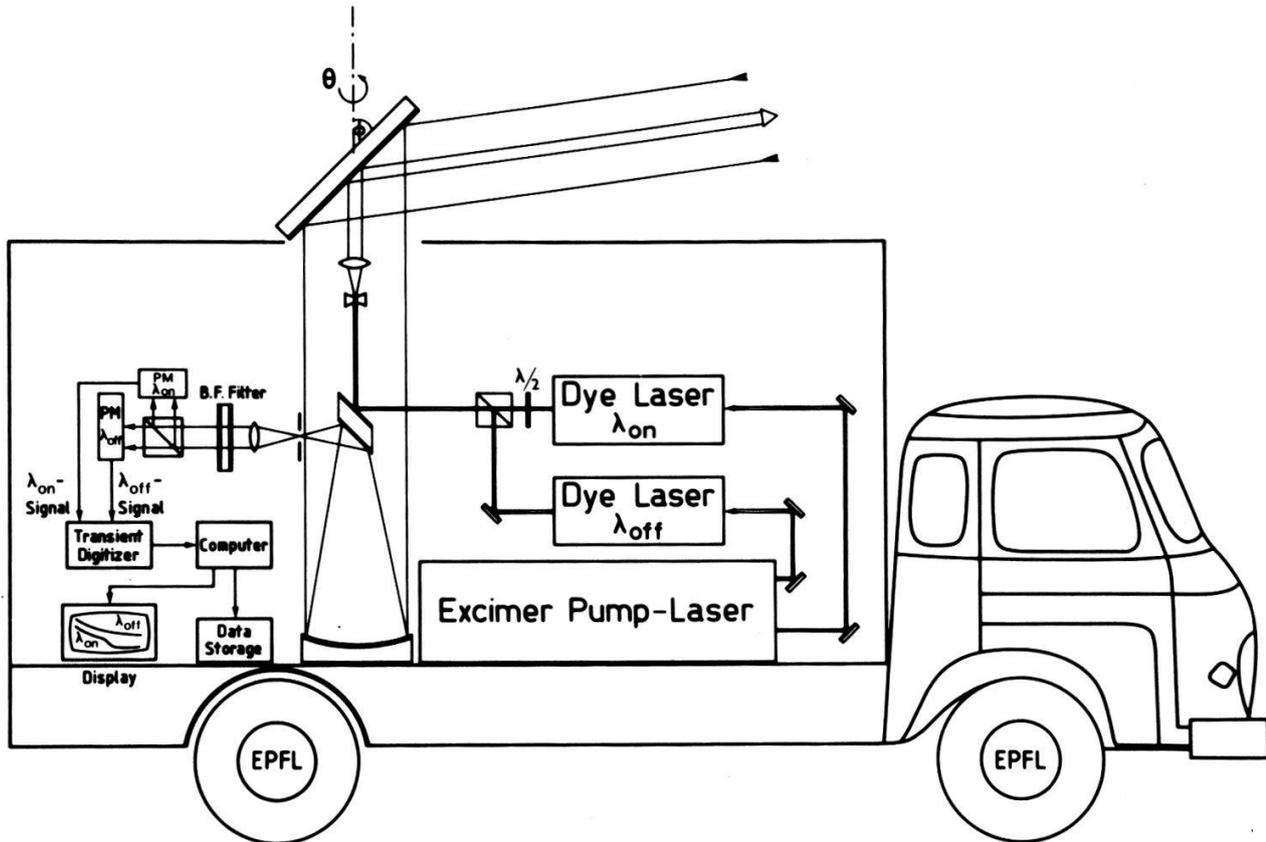
Fig. 7 : Montage expérimental.
