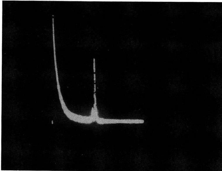
Fig. 5 : Signal de rétrodiffusion d'un nuage à 4 km.
