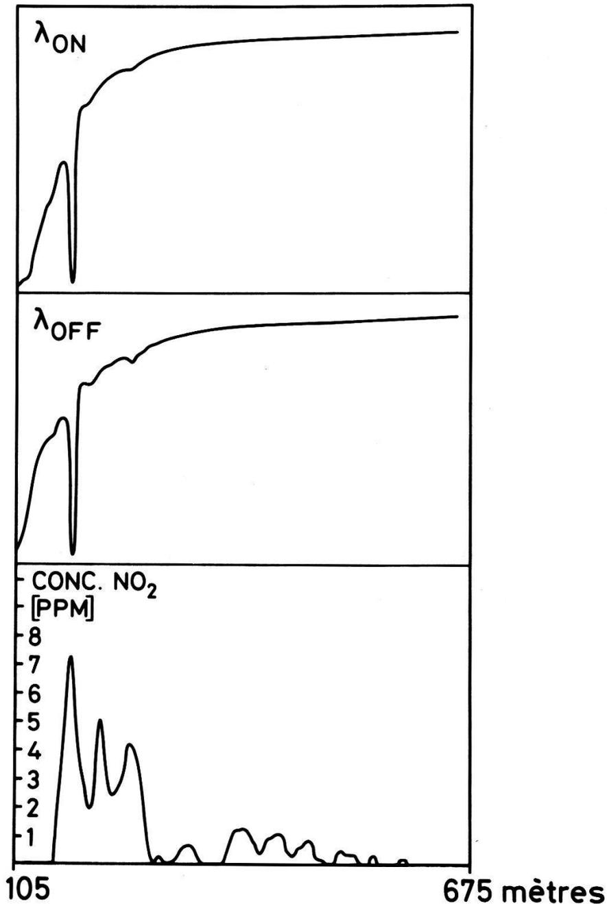
Fig. 8 : a) Signal obtenu pour une longueur d'onde absorbée par  $\text{NO}_2$  ( $\lambda_{\text{ON}}$ ).
