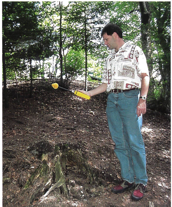
Bild 4. Tragbares Messgerät mit isotrop wirkender Antenne.
