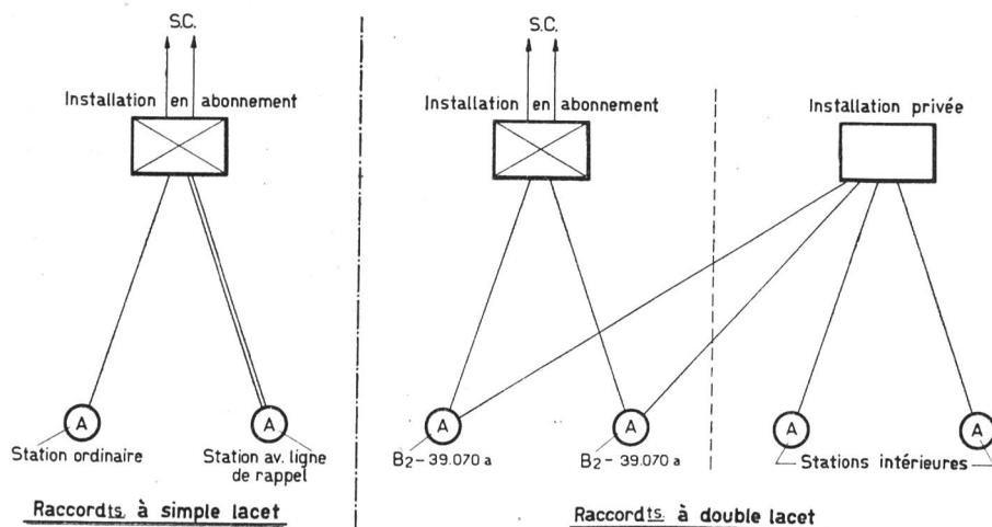
Fig. 1. Principschaltung des Ein- und Zweischleifenanschlusses. — Raccordements à simple ou double lacet (principe).
