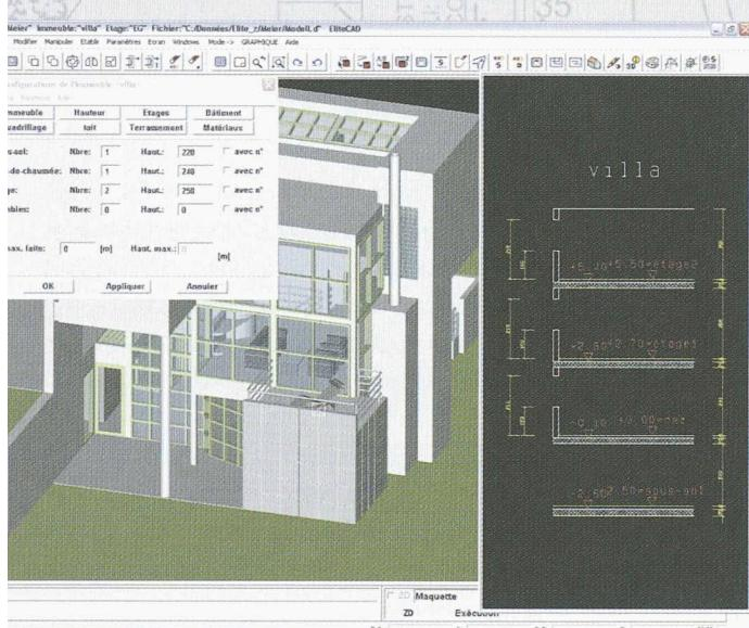
Elitecad permet au projeteur d'utiliser la technique traditionnelle du plan 2D, ainsi que les avantages de la visualisation 3D directe pour obtenir rapidement des coupes, perspectives et façades.
